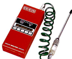
複合ガス検知器 GX-85N ●可燃ガス、酸素、有毒ガス(H 2 S、CO、CO 2 )用 ●有毒ガスは検知管方式で測定
