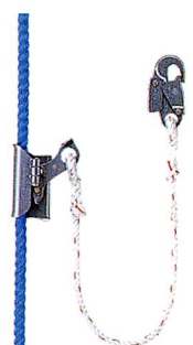
ロープチャック ●鉄塔・外壁面などの作業に ●下方は常時ロックで安全 ●グリップを握りながら下降 ●定位置作業可能 ●昇り方向はフリー ●適用親網:16~20mmφ
